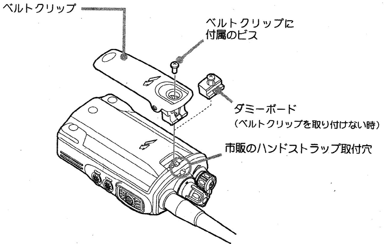
ベルトクリップの先端を指で押し、ベルトへ確実に取り付けてください。
