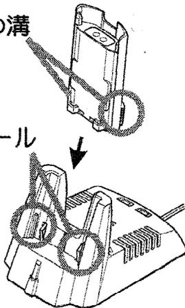
リチウムイオン電池パックを単体で充電するときは、リチウムイオン電池パックの溝を充電器内側のレールに合わせて差し込みます。
