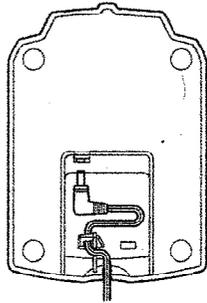
チャージャースタンドの底面にあるジャックに、ACアダプターのコネクターを差し込み、コードを配線します
