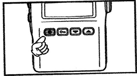
○ ロックが動作中に、ロータリースイッチや、各ボタンを押すと、ディスプレイに約1秒間“-LOCK-”が表示され、ロック中であることを知らせます。
